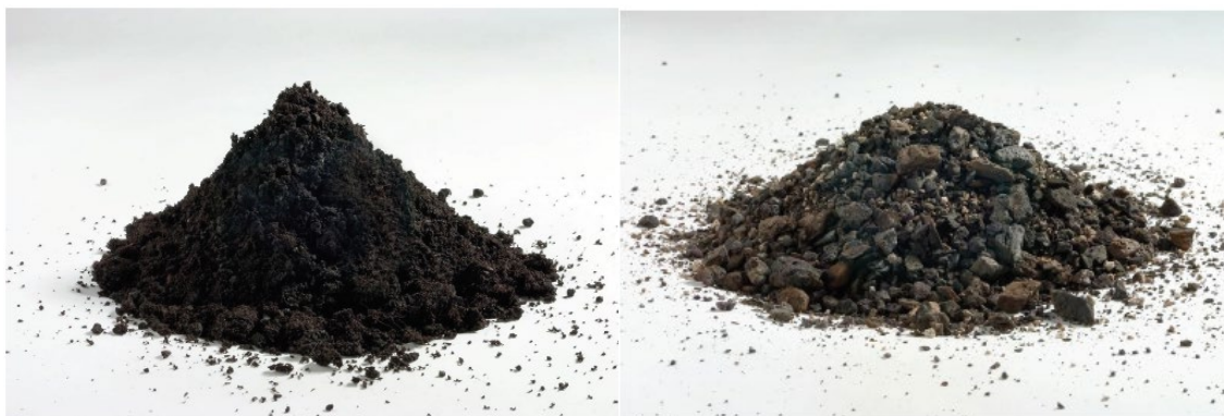
Obr. 24 Horná (vľavo) a spodná (vpravo) časť vegetačnej vrstvy (Zdroj: www.optigruen.co.uk )
