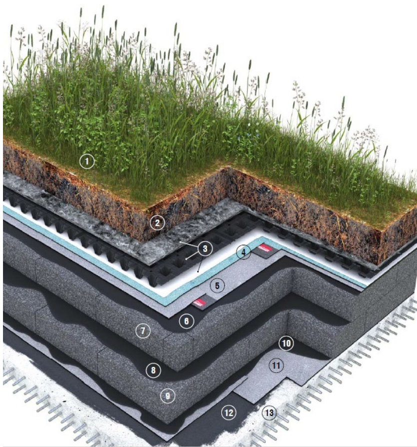
Obr. 29 HDPE nopová fólia (vrstva č. 3) výšky 40 mm s perforáciou v hornom povrchu, horný povrch recyklovaná PES rohož hrúbky 20 mm, spodný povrch kaširovaná PP textília 300 g/m 2 mm (Zdroj: Katalóg Vegetační střechy GREENDEK)
